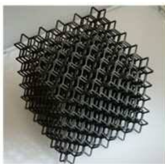
内部冷却構造の実現や軽量化
