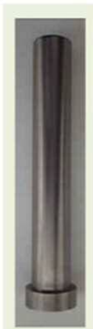
図4 金属3Dプリンターにて作製した超合金製の造形物
